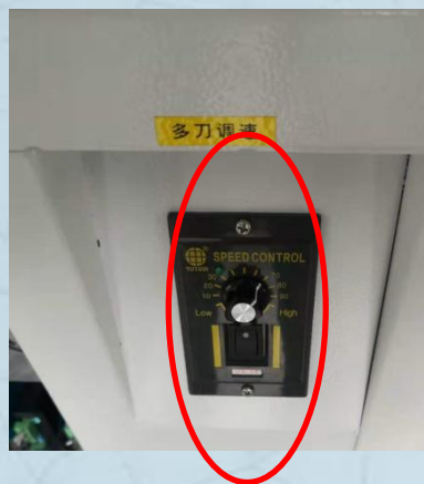
4、调速电机按钮没有盖住
